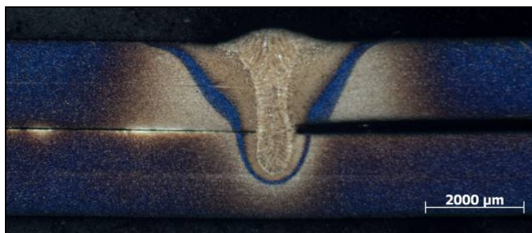
Figuur 4: Macrografie van een hybride stomp-overlap las in Docol 140 DP A M ultrahogesterkte staal, gelast aan 4,5 m/min met een laser Vermogen van 4 kW en de laser voorop.
